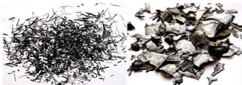
9 Сурет - Шоғырландырылған сәулелену ағынының әсерінен балқыманың ультрафитті түрде сөнуі арқылы алынған бастапқы прекурсорлардың үлгілері
